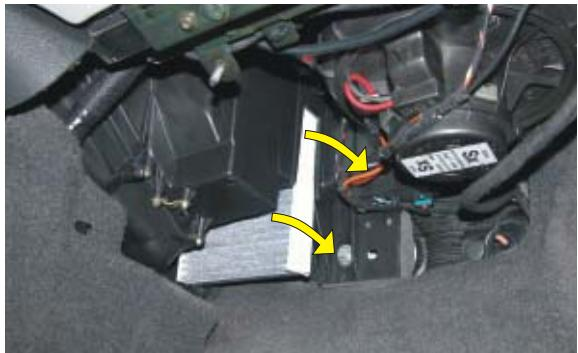
**(PL)** Ostrożnie usuwać zabrudzone filtry, wymienić je na nowe i wykonać powyższe czynności w kolejności odwrotnej
