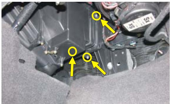
**(PL)** Odkręcić wkręty pokrywy filtra, usunąć pokrywę
